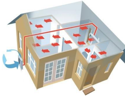
Εικόνα2.10: Απεικόνιση συστήματος αντλίας θερμότητας αέρα/αέρα
